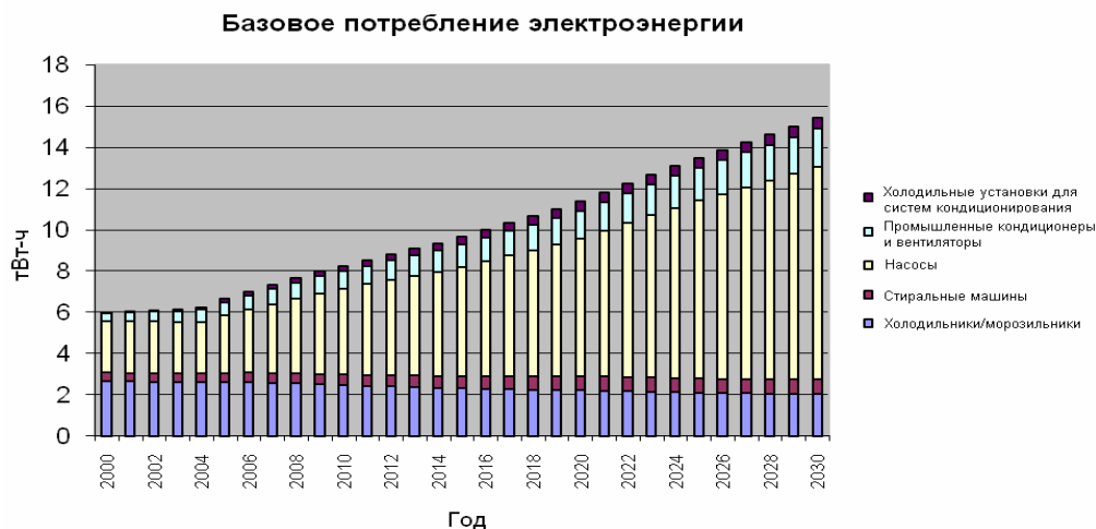
Диаграмма V-6: Базовое потребление электроэнергии wybranными бытовыми электроприборами и инженерным оборудованием зданий в пилотном Московском регионе(до 2030 г.)
